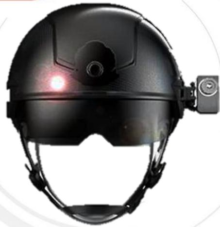
El casco inteligente captura la temperatura corporal del personal relevante en el rango de visión a través de la respuesta de milisegundos de la cámara infrarroja fijada en el casco, y presenta la información en la pantalla de realidad virtual en el casco a los ojos del usuario.
